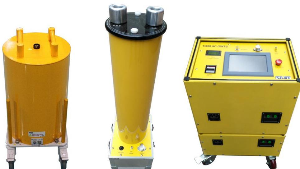
TQ30 串谐式振荡波电缆测试仪采用串联谐振与交流振荡波技术,可在现场一次性完成高压电力电缆的交流耐压试验和振荡波局部放电试验,评估电缆耐压能力,并检测、诊断和定位电缆本体和附件中的局部放电缺陷,广泛用于电缆的交接试验和预防性试验中。
