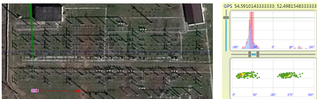
车辆位置 2 处局部放电源方向与 PRPD 图谱
