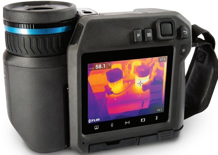
FLIR T560拥有卓越的分辨率和先进的功能,有助于专业人员排查发电、输配电及制造设备中的异常发热点,及时定位隐患和安排维护工作。FLIR T560采用手持式人体工程学设计,搭载180°旋转镜头平台和4英寸高亮度液晶屏,即使在难以接近的区域,也可帮助检查人员轻松、舒适地诊断电气或机械问题。借助一键式电平/跨度区域调节等高级内置测量工具和激光辅助自动对焦功能,确保每次都能准确记录温度测量数据。FLIR T560新增FLIR巡检选项(FLIR Inspection Route),可用于从FLIR Thermal Studio Pro软件\*下载和运行巡检规划。
