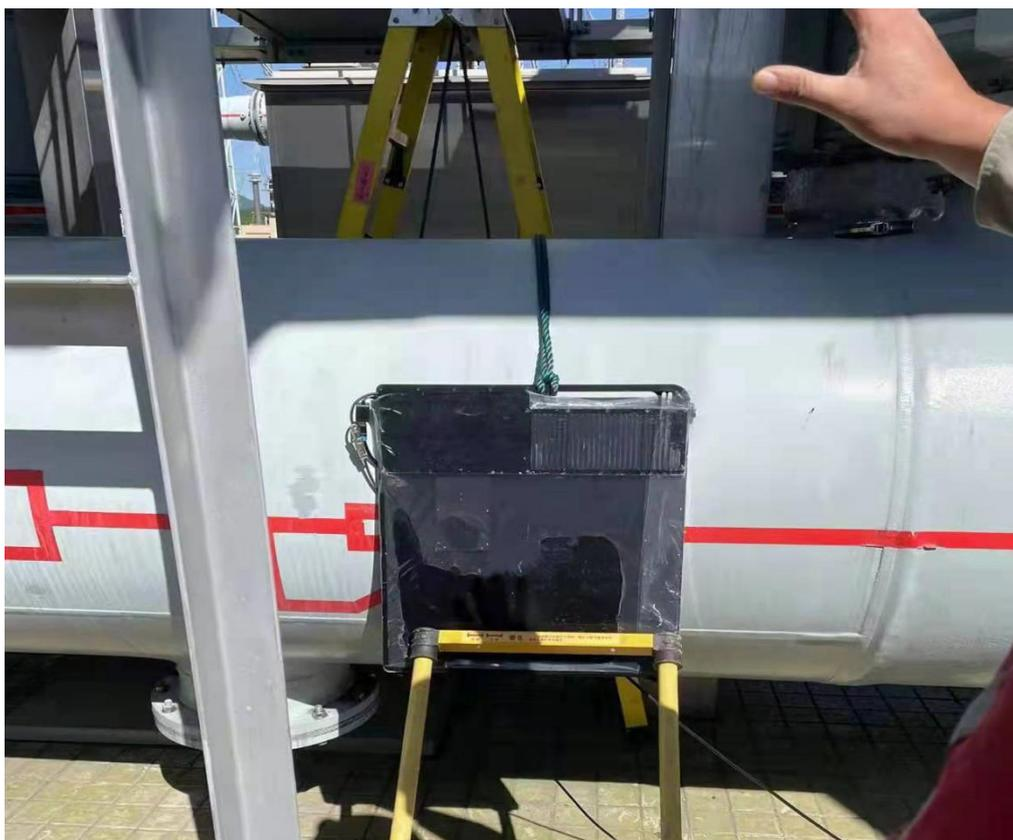
图 成像板简易安装拍片中
